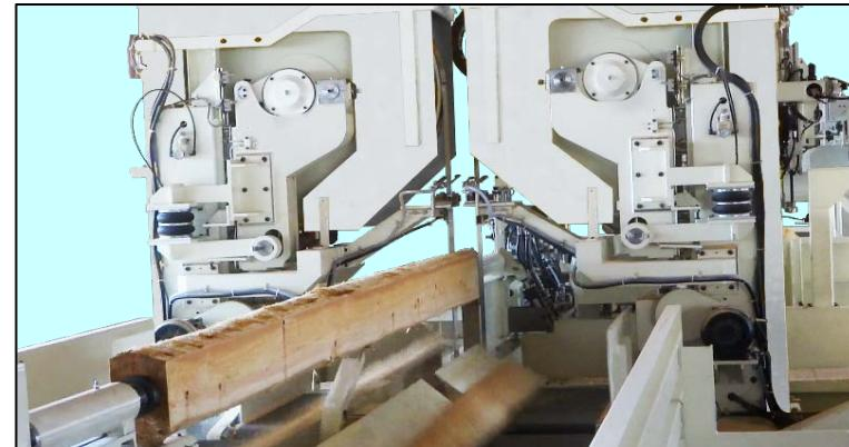
従来型のムダな動作を徹底排除。さらに、刃物にかかる負荷を予測して適切な送り速度に調整し、過負荷の場合には自動減速します。刃物の寿命を延ばしつつ加工時間の大幅短縮を実現し、
